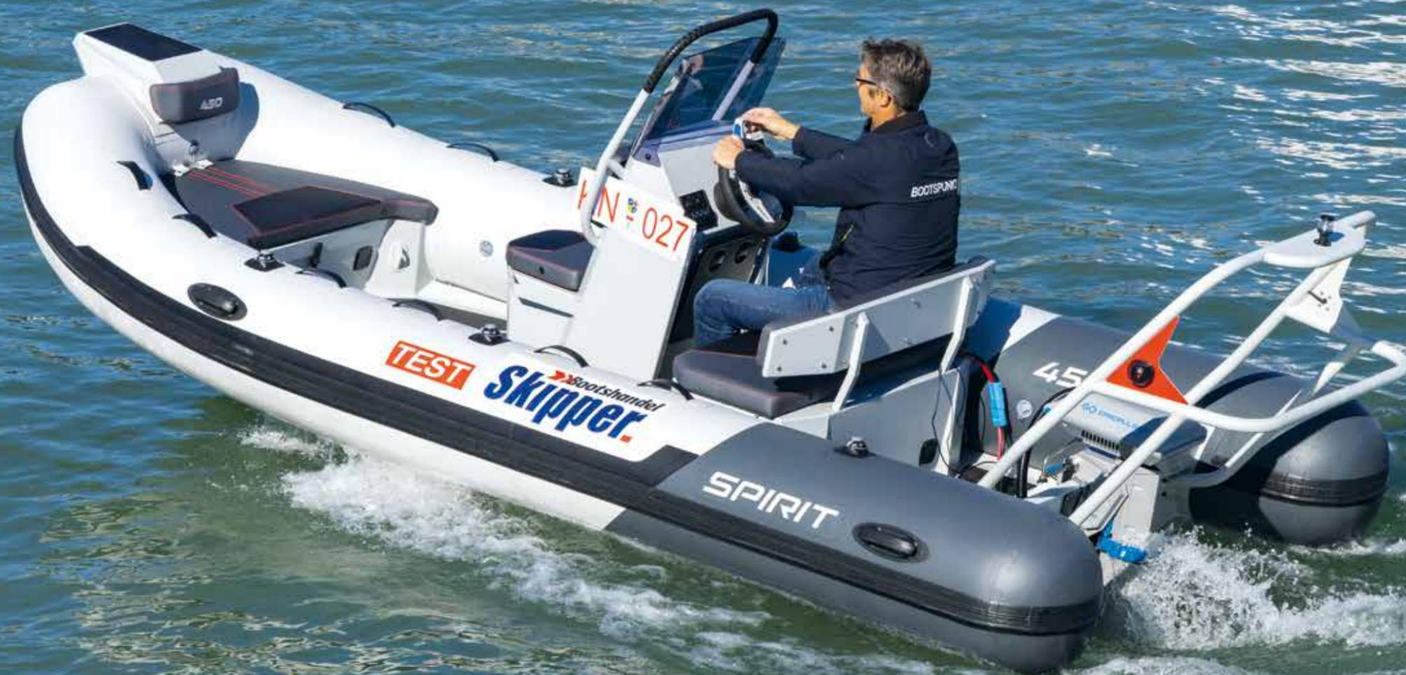
Beim Praxistest mit E-Motor blieb die variable AQS S450C logischerweise unter ihren Möglichkeiten. Mit einem 60-PS-Verbrenner am Spiegel erreicht das Boot mehr als 30 Knoten
